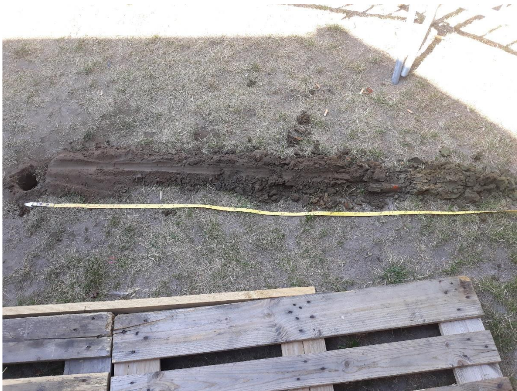
Foto 5: Bodemprofiel van het plein voor de eerste 2 meter (het profiel loopt van links naar rechts naar onder.
